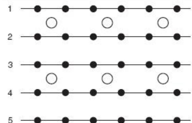
黑点表示采样该像素点的Y分量，以空心圆圈表示采用该像素点的UV分量
